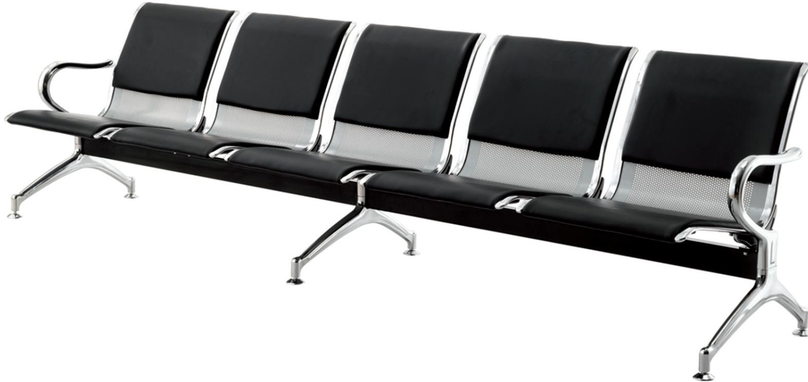
Sillón de espera en tandem de 2/3/4/5 asientos, cada uno construido por un bastidor perimetral, y asiento y respaldo formado por una pieza de chapa de acero perforada, de espesor de 2mm estampada con forma para cumplir su función. La terminación es con pintura en polvo epoxídica de color negro.
