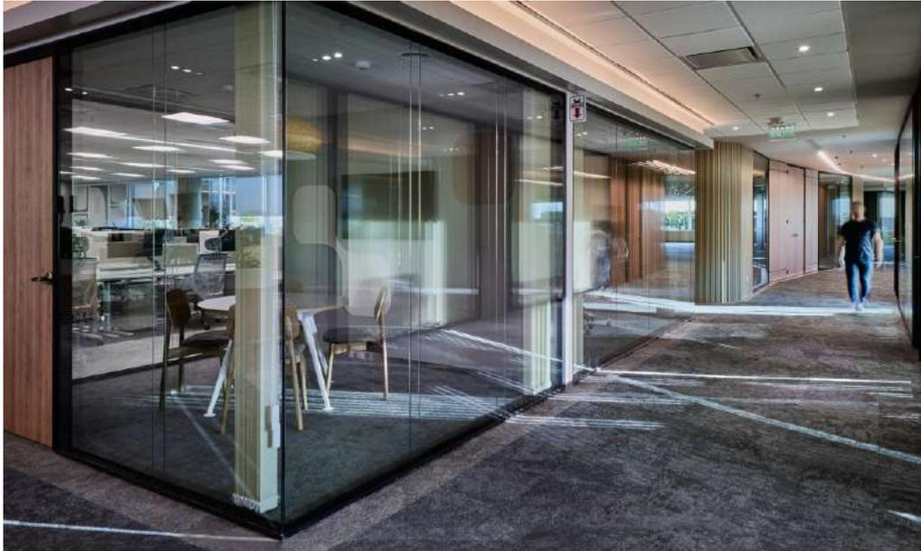
AWD Flat Box es un sistema de paneles divisorios, con doble plancha de vidrio y sin junta a la vista. De colocación rápida y efectiva, permite una colocación precisa y sencilla, siendo el material totalmente recuperable para su fácil reconfiguración.
